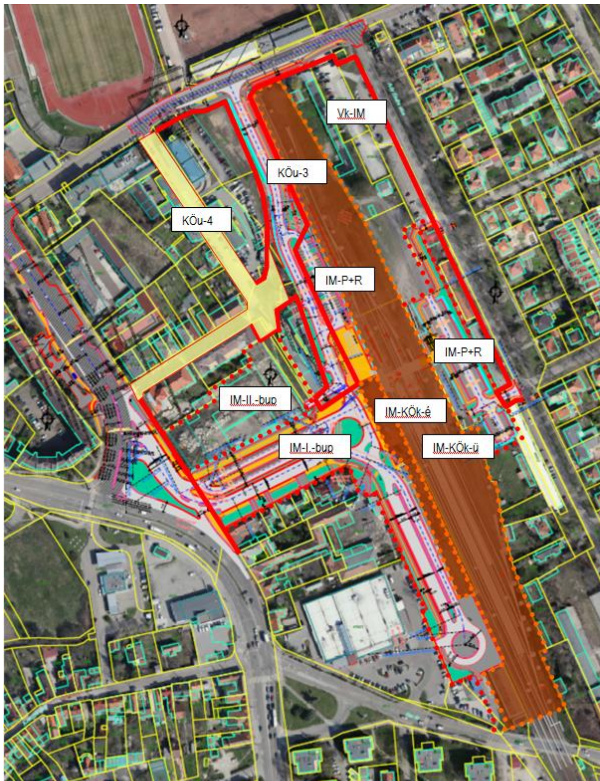
5. ábra: A tervezett szabályozás legfontosabb elemei, tervezett építési övezeti, övezeti besorolások (forrás: Eger tervezett IMCS kapcsán településrendezési eszközök módosítása)
